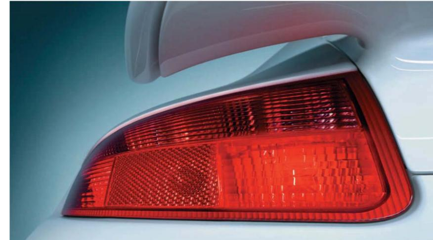
Heckleuchten mit komplett in Rot gestalteten Streuscheiben. Für einen besonders sportlichen und markanten Auftritt. Funktion und Maße entsprechen denen der Serienleuchten.
